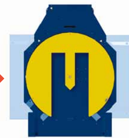
Vrtljiva plošča v obliki podkve; možnost dostopa s treh strani
