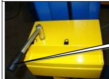
Figur 1 Break (2) frigivet (Black roll er ubremset)
