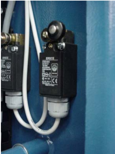
Kuva 4: Toimivatko kalvokelkan rajakytkimet oikein?
