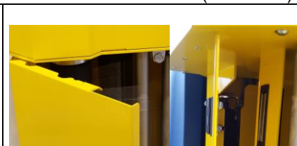
Vorderseite Rückseite Abb.3 E3 Folienschlitten mit Motor-Vorstreckungseinrichtung. Die Türen sind offen.
