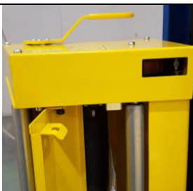
Abb.2 E3 Folienschlitten mit einer Rollenbremse. Die Tür ist offen.
