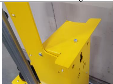
Abb.1 E3 Folienschlitten mit Rollenkernelbremse. Die Bremses ist gedrückt.
